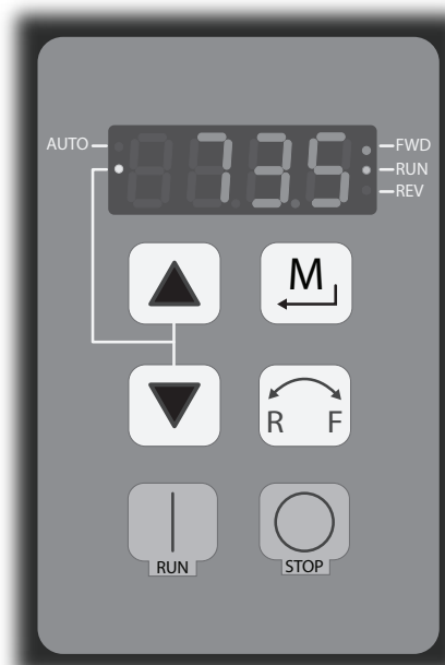
Pantalla que muestra la velocidad del ventilador en porcentaje (funcionando al 73.5% en dirección de avance)
