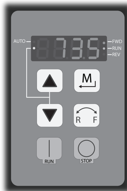
Affichage de la vitesse de rotation en pourcentage (tourne à 73,5 % en marche avant)
